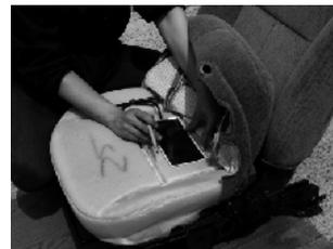
4. ケーブルと温度センサーを逃がす為の切り込み作り
