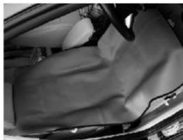
2. シートカバーをシート本体からはずし、シートカバー裏面に発熱シートの黒い面がシートカバーと接するように貼り付けます。
