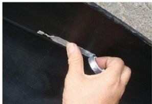
③センサー部のアルミ粘着リボンアンテナをバンパー裏側に貼り付けます。
