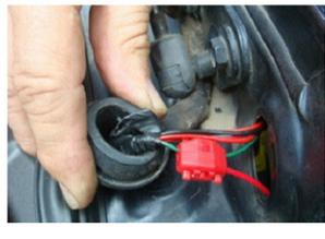
⑩バックランプの配線から点灯時に12V流れる線に電源線を分岐・接続します。
