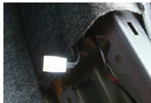
⑥本体ユニットとの接続に必要な長さを確保して、残りを全て外に引き出します。
