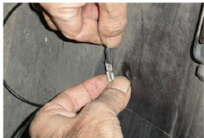
⑦引き出したアンテナコード線をバンパー裏に貼り付けたセンサーに接続します。
