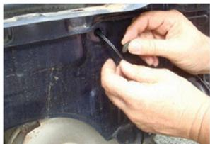
⑤トランクに通じたグロメットを利用してアンテナコード線を外に引き出します。
