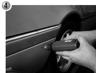
④ モールセンサー線を車室内に引き込む為の穴を開けます。
