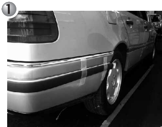
① モールセンサーをバンパー全体の長さに合わせながら仮止めします。
