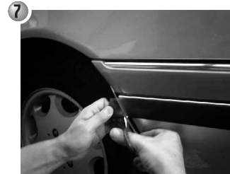
⑦ 余分な線を切って端を合わせます。付属のエンドモールは任意でご使用下さい。
