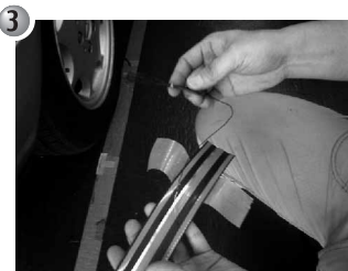
③ 合わせた時にセンサー線の位置を確認し、穴あけ位置をマーキングします。
