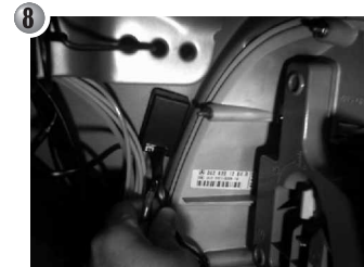
⑧ トランク内に本体を貼り付け設置します。
