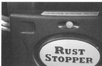
本体上部のインジケーターが、作動中であることを知らせてくれる。消費電流は3mA程度と非常に少ないが、万一バッテリーの電圧が12.1Vいかに低下すると自動的にストップする。
