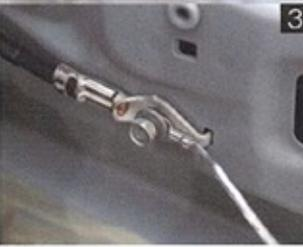
3 ラストロッパーの装着は、あっけないほど簡単。要はバッテリーとアース線をつないで、バルス線をボディに取り付けられおしまい。1.まずは、本体から伸びる赤色の配線を、バッテリーのプラスターミナルに接続する。2.次に、黒色の配線を、バッテリーのマイナスターミナルに接続する。3.最後に、クリア皮膚のバルス線を、ボディの金属部分(車種により、配置箇所は異なるが、例えば、エンジンルームやシートレールのボルト部分など)に装着すれば完了だ。
