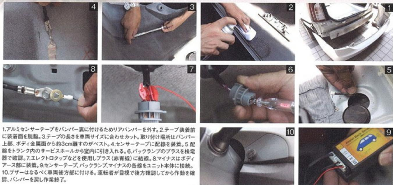
1.アルミセンサーテープをバンパー裏に付けるためリアバンパーを外す。2.テープ装着前に装着面を脱脂。3.テープの長さを車両サイズに合わせカット。取り付け場所はバンパー上部、ボディ金属面から約3cm離すのがベスト。4.センサーテープに配線を装着。5.配線をトランク内のサービスホールから室内に引き入れる。6.バックランプのプラスを検電器で確認。7.エレクトロタップなどを使用しプラス(赤青線)に結線。8.マイナスはボディアース部に装着。9.センサーテープ、バックランプ、マイナスの各線をユニット本体に接続。10.プザーはなるべく車両後部に付ける。運転者が目視で後方確認してから作動を確認、バンパーを戻し作業終了。
