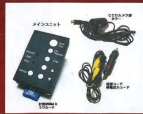
まだドライブレコーダーが一般化されていない2006年頃に、ツーフィットが開発したドライブレコーダー。別体式の大きなCCDカメラや、わずか256MBのSDカードが時代を感じさせる。
