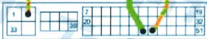
灰/黒コネクター (それぞれ1個ずつのコネクターが上下にあります。灰色:12V電源・黒:CAN信号)
